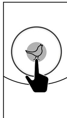
Um nach dem ersten Set-up das WLAN-Netz später noch einmal zu ändern, das Vogel-Logo 2 Sekunden lang drücken, bis das Licht blinkt
